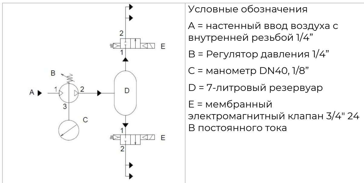
Табл.31 : Пневматическая схема BC20 PLUS
